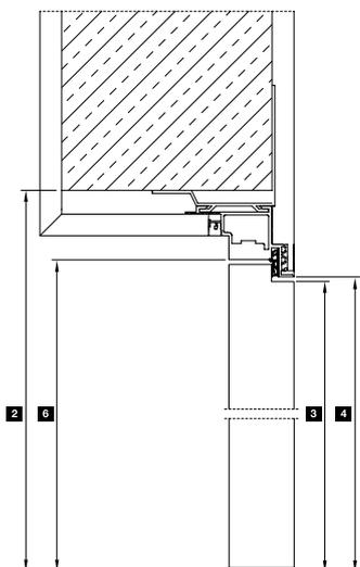
Horizontalschnitt mit reverse-öffnendem Türblatt
