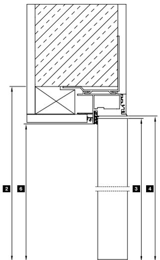
Horizontalschnitt mit stumpfem Türblatt
